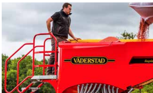
Rapid A 400-800S má uprostřed umístěnou pracovní plošinu s přístupem z obou stran, což obsluhu šetří čas.
